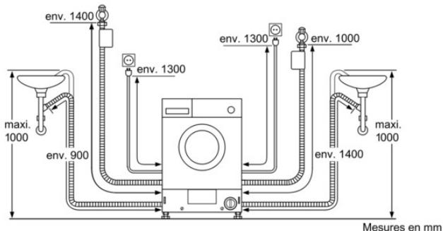
Si le flexible d'arrivée d'eau Aqua-Stop n'est pas assez long pour l'installation, il est possible de le rallonger avec la garniture de raccordement WZ 10130 (longueur 2,5 m).
