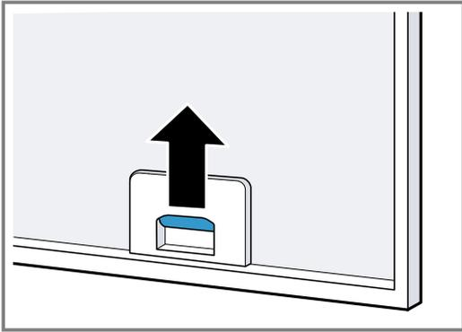
3. Wyjąć filtry przeciwtłuszczowe z mocowań. Aby zapobiec skapywaniu tłuszczu, filtry przeciwtłuszczowe należy trzymać w pozycji poziomej.
