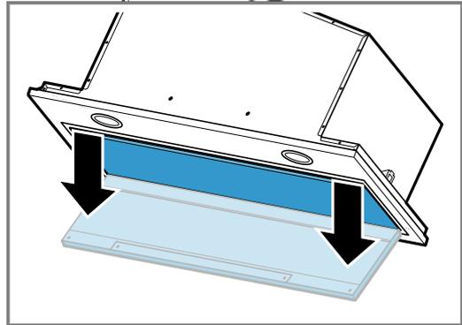
3. Die Scharniersicherung lösen und die Filterabdeckung entfernen.
