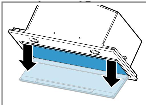
3. Démontez le dispositif de sécurité de la charnière et retirez le capot du filtre.
