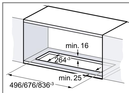
2. Wycięcie pod rurę powietrza wylotowego wykonać powyżej mebla do zabudowy lub za meblem do zabudowy.
