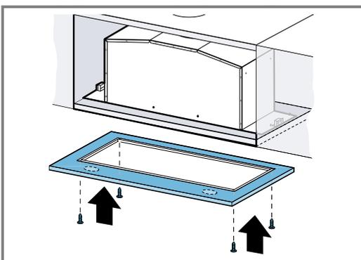
4. Den Rahmen und das Gerät mit Schrauben sichern.
