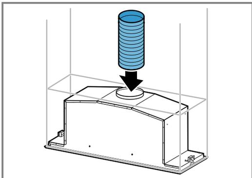
2. Wykonać połączenie z otworem powietrza wylotowego.
