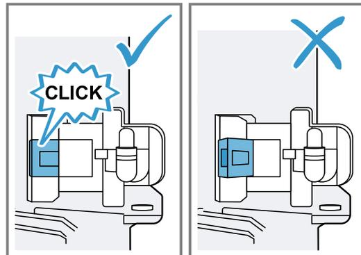
7. Insérez le filtre à graisse.
