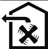
Powietrza nie wolno odprowadzać do komina, który jest używany do odprowadzania spalin z urządzeń spalających gaz lub inne paliwa (nie dotyczy urządzeń użytkowanych w trybie obiegu zamkniętego).
