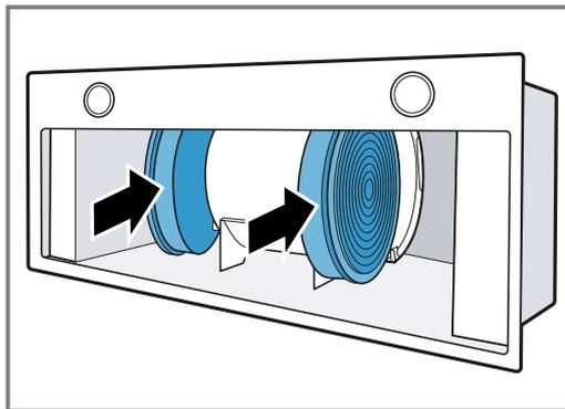
4. Zamontować filtry przeciwtłuszczowe.
