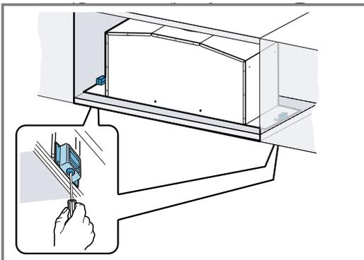
3. Den Rahmen anbringen und von unten mit dem Gerät verschrauben.
