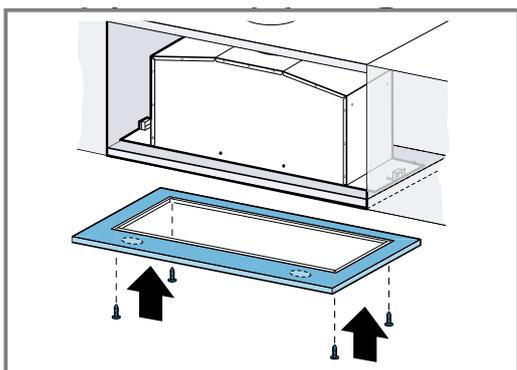
4. Ramę i urządzenie zabezpieczyć śrubami.
