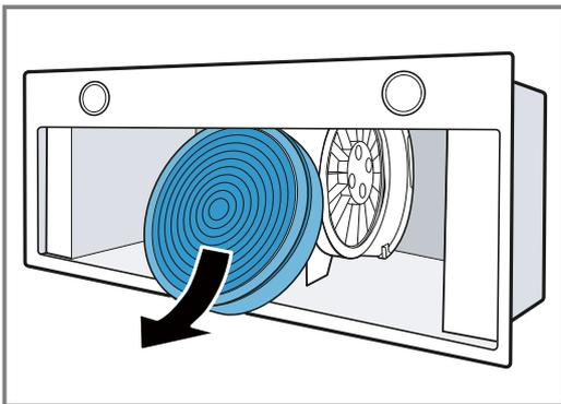
3. Pousser le filtre anti-odeurs avec précaution dans le support de fixation.
