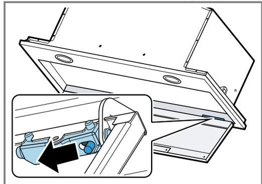
4. Die Fettfilter entnehmen. Die Fettfilter nicht biegen, um Beschädigungen zu vermeiden.
