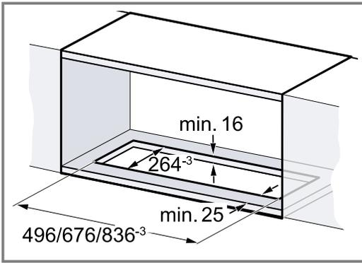
2. Den Ausschnitt für das Abluftrohr entweder oberhalb des Einbaumöbels oder hinter dem Einbaumöbel herstellen.
