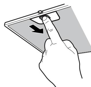
2. Sortir le filtre métallique à graisse de sa fixation.
