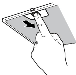
2. Metallfettfilter aus der Halterung herausnehmen.
