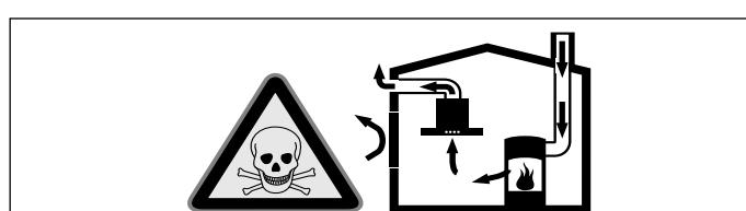
Raumlufthaftige Feuerstätten (z.B. gas-, öl-, holz- oder kohlebetriebene Heizgeräte, Durchlauferhitzer, Warmwasserbereiter) beziehen Verbrennungsluft aus dem Aufstellraum und führen die Abgase durch eine Abgasanlage (z.B. Kamin) ins Freie.
