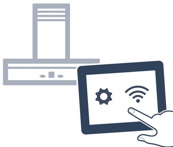
Lorsque la connexion a été établie, la hotte aspirante se connecte automatiquement à l'appli Home Connect. La LED 3 et la LED 7 clignotent.
