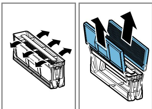
2. Placez les différents composants du filtre à graisse dans le lave-vaisselle sans les serrer les uns aux autres.
