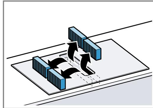
4. Insérez les 2 filtres anti-odeurs ou acoustiques à gauche et à droite de l'appareil, puis poussez-les vers l'avant.
