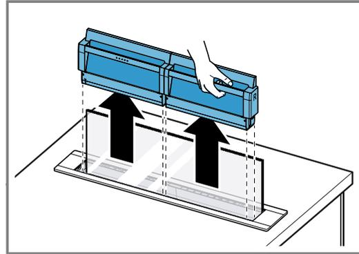
3. Retirez le filtre à graisse. Ne pliez pas le filtre à graisse, afin d'éviter tout endommagement.
