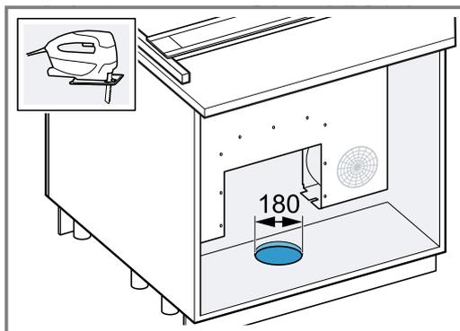
6. Glissez le boîtier du ventilateur dans le guide, créez la tuyauterie et vissez le boîtier du ventilateur.
