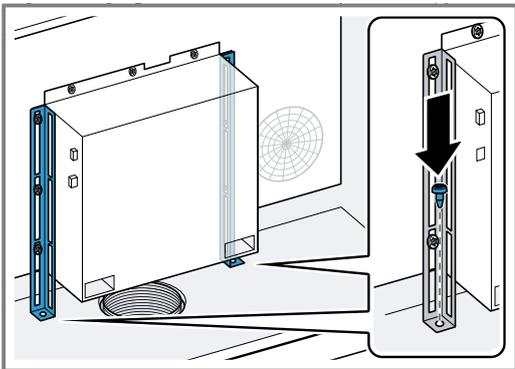
11. **Remarque** : Si un appareil de 90 cm est monté dans une armoire de 90 cm de large, ignorez les deux étapes de montage suivantes et suivez les instructions figurant dans le pack d'accessoires supplémentaires.
