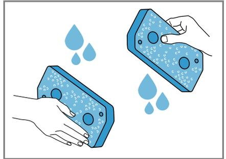
Vous pouvez retirer soigneusement les salissures importantes avec un aspirateur. Ne nettoyez pas le matelas filtrant avec des produits de nettoyage.
