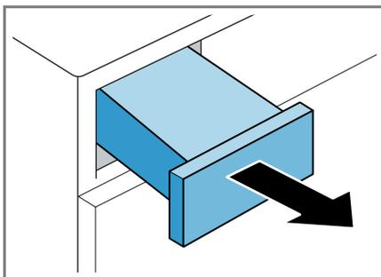
2. Vider le réservoir d'eau de condensation.
