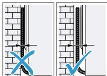
Ne coincez aucun tuyau ni aucun cordon d'alimentation secteur entre le mur et l'appareil.
