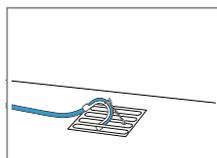
Poussez le tuyau d'évacuation d'eau complètement à travers le et fixez-le avec le matériel de fixation. Fixez le coude sur la bouche d'évacuation.
