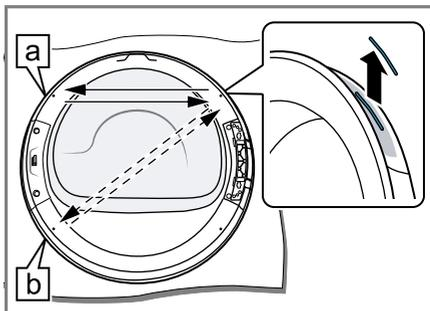
Choisissez la position de l'indicateur de poignée du hublot en fonction du lieu d'installation de l'appareil :
