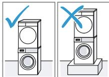
Installez cet appareil uniquement dans une colonne lave-linge/sèche-linge à l'aide du kit de raccordement d'origine du fabricant du sèche-linge.
