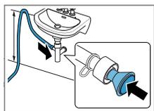
Fixez le point de raccordement avec un collier de serrage (12-22 mm). Fixez le tuyau d'évacuation d'eau avec un
