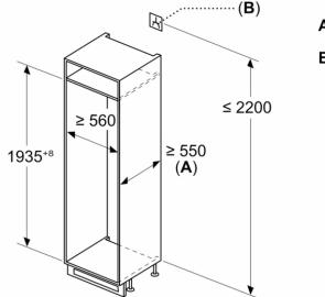
**A:**  $\geq 560 \text{ mm}$  (recommandé)
