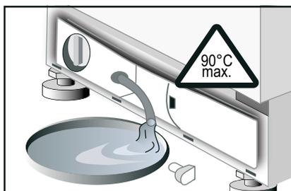
4. Dévissez prudemment le couvercle de la pompe ; de l'eau résiduelle risque de s'écouler. Nettoyez le corps de pompe et retirez les corps étrangers. Le rotor de la pompe de vidange doit pouvoir tourner librement.
