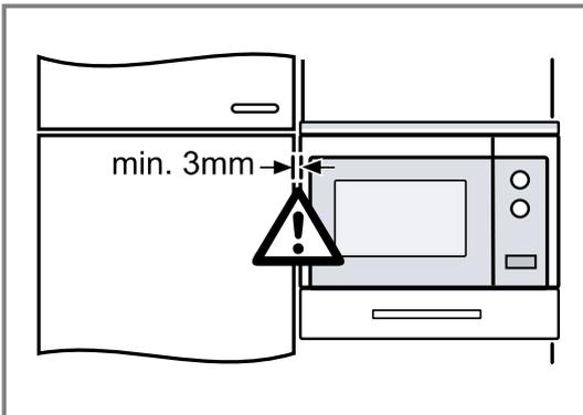
La distance par rapports aux appareils adjacents doit d'être d'au moins 3 mm.
