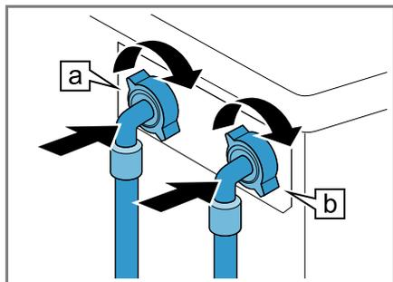
2. Raccordez le flexible d'arrivée d'eau chaude **a** (rouge) et d'eau froide **b** (bleu) au robinet d'eau (26,4 mm = 3/4").
