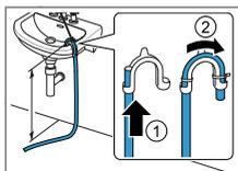
Poussez le tuyau d'évacuation d'eau complètement à travers le coude et fixez-le avec le matériel de fixation. Fixez le coude à une hauteur de
