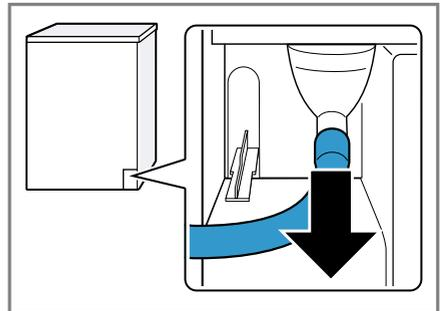
Le tuyau d'eau de condensation est raccordé au manchon en usine.
