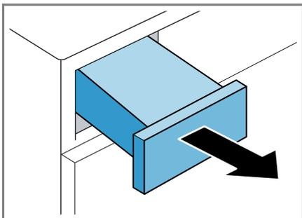
2. Vider le réservoir d'eau de condensation.
