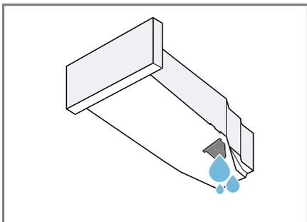
Vérifiez régulièrement le filtre du réservoir d'eau de condensation et
