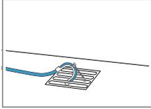
Poussez le tuyau d'évacuation d'eau complètement à travers le coude et fixez-le avec le matériel de fixation. Fixez le coude sur la bouche d'évacuation.
