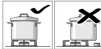
Stellen Sie die Töpfe auf die Roste, niemals direkt auf die Brenner. Vergewissern Sie sich vor der Benutzung, dass die Topfroste und die Deckel der Gasbrenner korrekt aufliegen.
