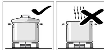
Stellen Sie das Kochgefäß mittig über den Brenner, sonst kann das Gefäß umkippen. Stellen Sie große Töpfe nicht auf die Brenner in der Nähe der Armaturen. Diese könnten überhitzt und dadurch beschädigt werden.
