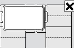
Le récipient ne doit pas recouvrir simultanément les deux zones de cuisson FlexPlus.
