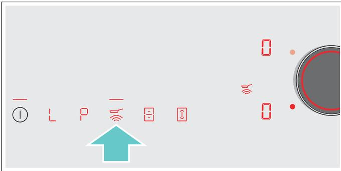
2. Dans les 5 secondes qui suivent, sélectionner le niveau de température souhaité avec le bouton Twist.
