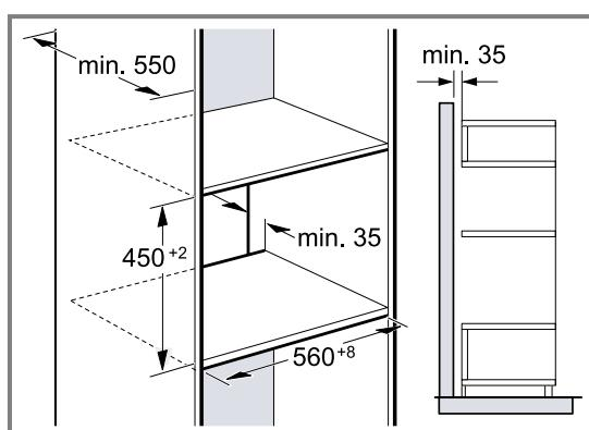
Wenn der Hochschrank zusätzlich zu den Element-Rückwänden eine weitere Rückwand hat, muss diese entfernt werden.
