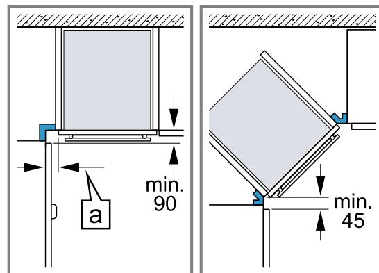
Ahhoz, hogy a készülék ajtaját ki lehessen nyitni, a sarkbeépítésnél vegye figyelembe a minimális méreteket. A méret  $\Delta$  függ a bútorlap és a fogantyú vastagságától.
