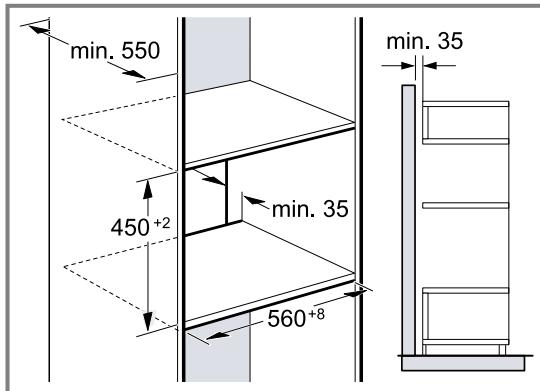
Si le meuble haut possède un panneau arrière en plus des panneaux arrière préfabriqués, celui-ci doit être enlevé.
