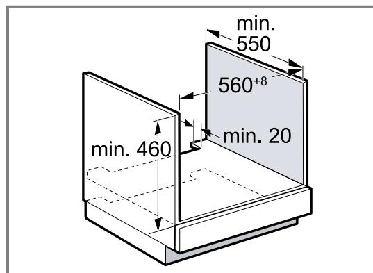
Le plan de travail doit être fixé sur le meuble d'encastrement.
