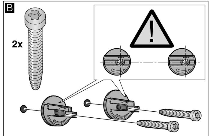
3. Visser le boulon fileté de sorte qu'il dépasse encore de 5 - 9 mm du mur. **C**
