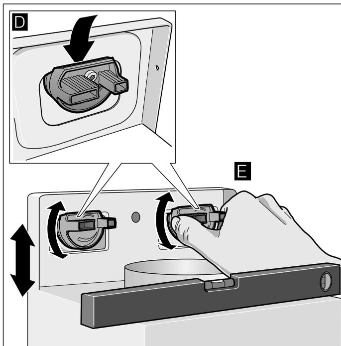
4. Serrer les vis des pièces d'accrochage. Ce faisant, retenir les pièces d'accrochage. **F**
