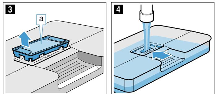
7. Insérer à nouveau le cache **a** dans l'orifice sur le réservoir d'eau.
