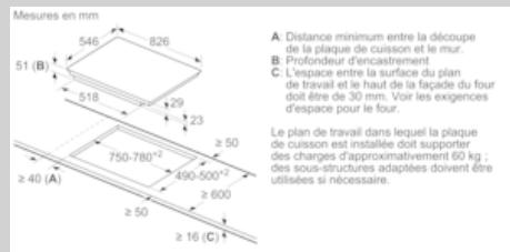
A: Distance minimum entre la découpe de la plaque de cuisson et le mur.
