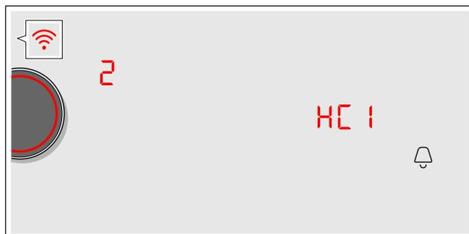
5. Connectez un terminal mobile au réseau de la table de cuisson avec la SSID « HomeConnect » et le code « HomeConnect ».
