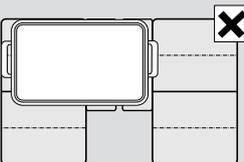
Le récipient ne doit pas recouvrir simultanément les deux zones de cuisson FlexPlus.
