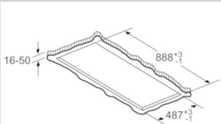
Ne pas monter directement sur un faux plafond constitué de plaques de plâtre ou d'un matériau de construction léger similaire. Il est impératif d'utiliser un support adapté et solidement fixé dans la dalle en béton.
