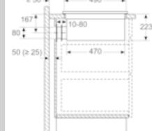
En cas d'installation directement contre des murs extérieurs qui ne sont pas isolés ( $\mu \geq 0,5 \text{ W/m}^2 \cdot \text{°C}$ ), nous recommandons d'utiliser des configurations de recyclage partiellement ou totalement gainées.
