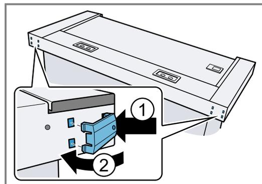
2. Branchez le câble secteur fourni à l'appareil et fixez-le avec la décharge de traction.
