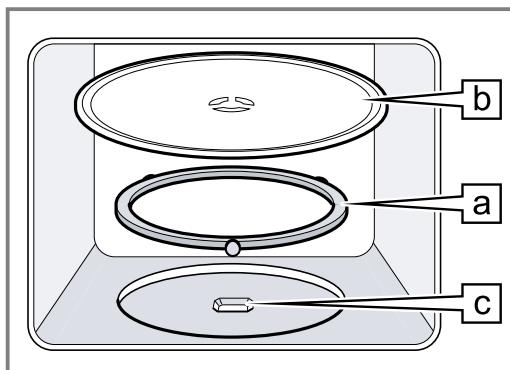
2. Incastrare il piatto girevole **b** nell'elemento di trasmissione **c** che si trova al centro del fondo del vano di cottura.
