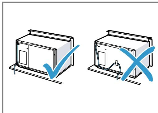
Τοποθετήστε τη συσκευή στο ντουλάπι και οπρώξτε τη προς τα δεξιά.
