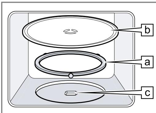
2. Engager le plateau tournant **b** dans l'entraînement **c** au centre du fond du compartiment de cuisson.
