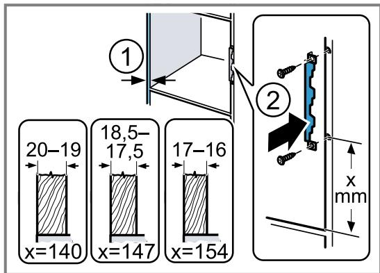
3. Het apparaat zo lang vastschroeven tot het apparaat in het midden is uitgelijnd.
