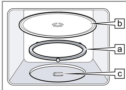
2. Ασφαλίστε τον περιστρεφόμενο δίσκο **b** στον μηχανισμό κίνησης **c** στη μέση του πάτου του χώρου μαγειρέματος.
