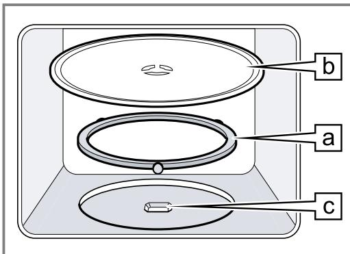
2. De draaischijf **b** in de aandrijving **c** in het midden van de bodem van de binnenruimte vergrendelen.
