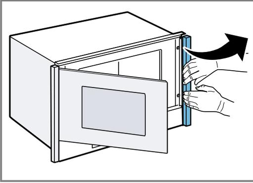
4. Falls sich bei der Demontage der Blenden die Befestigungselemente gelöst haben, diese wieder befestigen. Dazu das Befestigungselement unten einhängen und oben andrücken, bis es anliegt.
