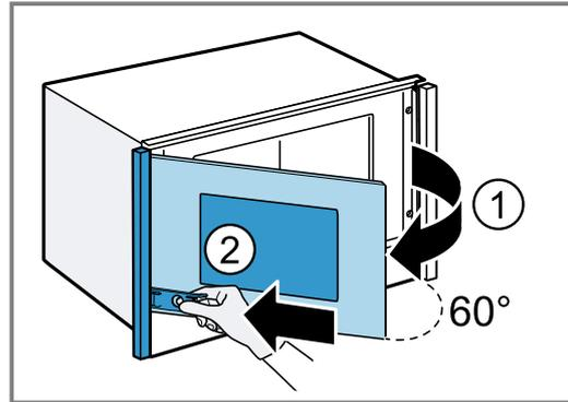
2. Pour détacher le bandeau, fermez la porte de l'appareil ① ② en appuyant sur l'élément de fixation contre la porte de l'appareil et en direction du bandeau.
