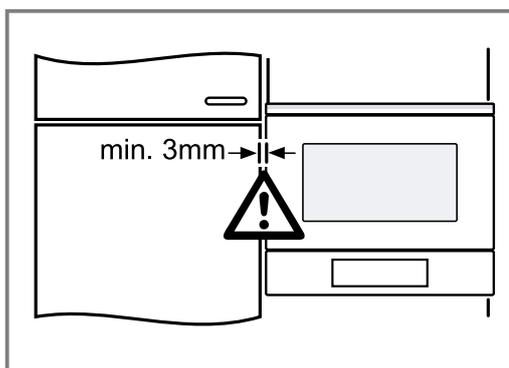
Une fente d'aération d'au moins 3 mm est nécessaire entre l'appareil et la façade des meubles adjacents.
