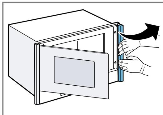
4. Wanneer bij de demontage van de afdekkingen de bevestigingselementen los zijn geraakt, deze weer bevestigen. Daarvoor het bevestigingselement aan de onderzijde inhangen en boven aandrukken totdat deze er tegen aan ligt.
