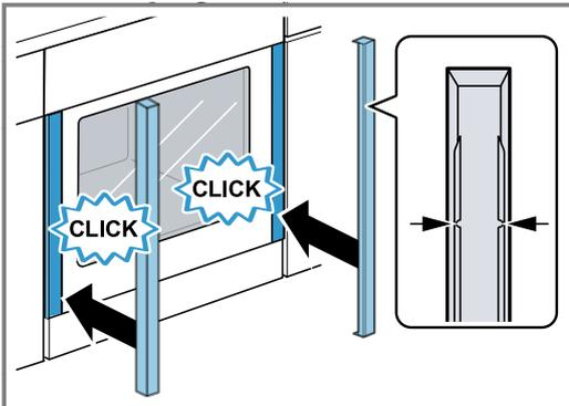
La flèche à l'intérieur des bandeaux doit être orientée vers le haut.
