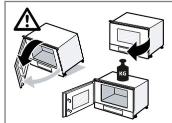
1. Die Gerätetür 60° öffnen ① und ein Befestigungselement direkt oberhalb der Bedienblende zwischen die Gerätetür und die Blende schieben ②.
