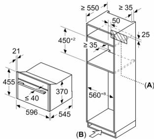
**A:** Espace pour le raccordement de l'appareil 300 x 200 mm
