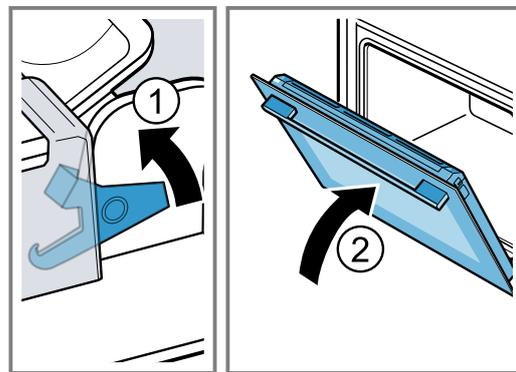
4. Appuyez sur le recouvrement de la porte à gauche et à droite à l'extérieur de la porte de l'appareil **1** jusqu'à ce qu'il se débloque.
