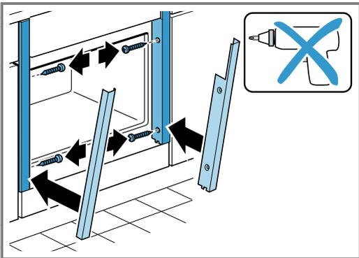
7. Si nécessaire, ajuster l'espace entre la porte de l'appareil et les caches latéraux en agissant sur la vis supérieure à gauche et à droite.
