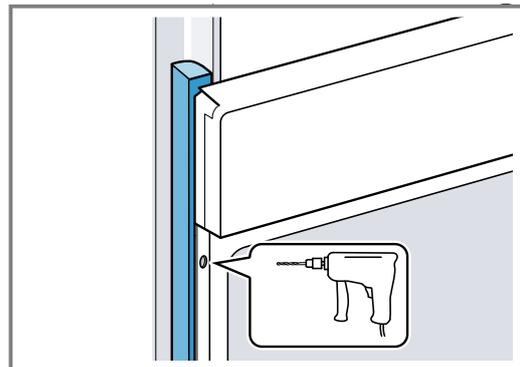
3. Fixer l'appareil avec une vis adéquate.
