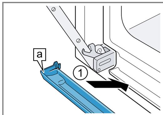
2. Engager les crochets **a** du bac de condensation à gauche et à droite dans l'espace **1**.
