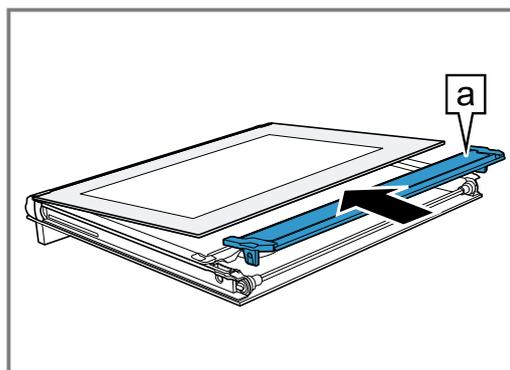
8. Insérer la vitre intérieure avec la fixation [a] dans l'ouverture.
