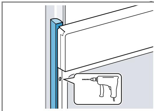
3. Fixer l'appareil avec une vis adéquate.
