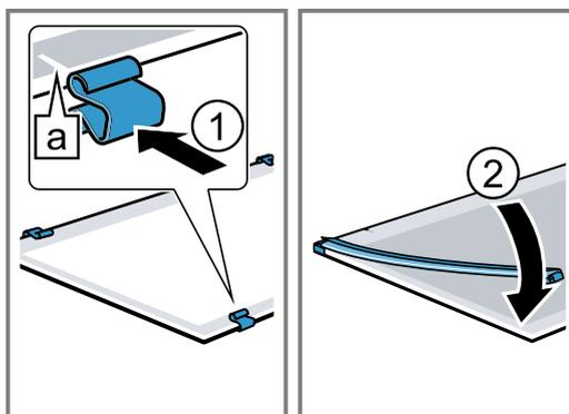
3. Placez la vitre intermédiaire avec les joints et les écarteurs dans le sens de la flèche ①. La flèche sur la vitre intermédiaire doit correspondre avec celle du cadre [a].
