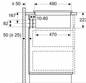
En cas d'installation directement contre des murs extérieurs qui ne sont pas isolés ( $\mu \geq 0,5 \text{ W/m}^2 \text{ } ^\circ\text{C}$ ), nous recommandons d'utiliser des configurations de recyclage partiellement ou totalement gainées.
