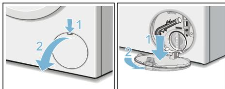
4. Sortez le flexible de vidange de son support. Retirez le bouchon de fermeture, laissez le bain lessiviel s'écouler dans un récipient adéquat. Enfoncez le bouchon de fermeture et mettez le flexible de vidange en place dans le support.
