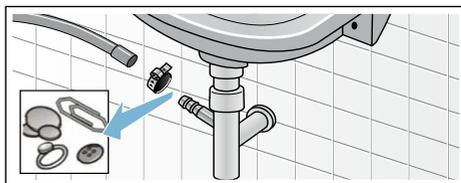
4. Remmancher le flexible d'évacuation et sécuriser le point de raccordement à l'aide du collier du flexible.
