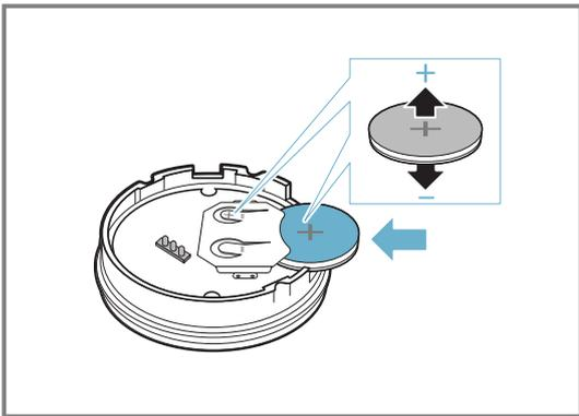
**Remarque :** Ne pas utiliser d'objet métallique pour retirer la pile. Ne pas toucher les bornes de la pile.
