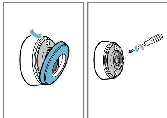
2. Ouvrir le couvercle du capteur pour casserole et retirer la pile du socle.
