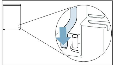
5. Retirez le tuyau d'évacuation de l'accessoire et poussez-le jusqu'en butée sur les supports détachés.
