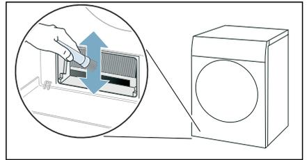
**Remarque :** Veillez à nettoyer les lamelles de l'échangeur thermique du haut vers le bas, et à ne pas les plier ni les endommager.
