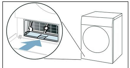
10. Insérez le couvercle de l'échangeur thermique à la poignée.
