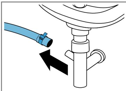
4. Nettoyez le tuyau d'évacuation d'eau et l'embout du siphon.
