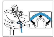
Écoulement dans un tuyau en plastique avec manchon en caoutchouc ou dans un avaloir d'égout.
