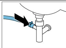
Écoulement dans un lavabo.
