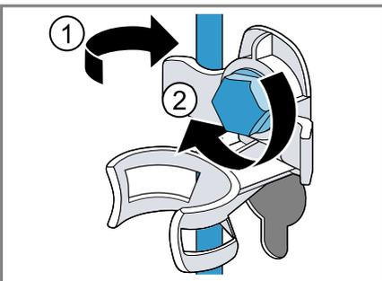
5. Insérez le tuyau dans le support.
