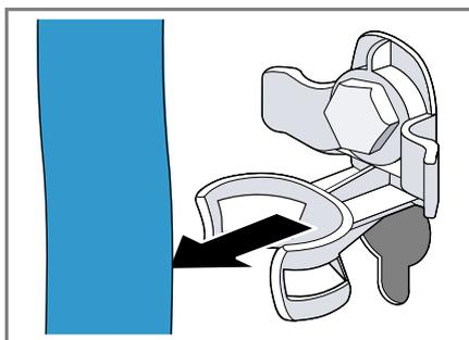
2. Dévissez les 4 vis des cales de transport à l'aide d'une clé à vis de calibre 13 ① et retirez-les ②.
