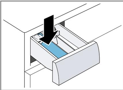
Pour éviter la formation de mousse, utilisez uniquement la moitié de la quantité de lessive recommandée par le fabricant pour du linge légèrement sale. N'utilisez pas de lessive pour lainages ni pour linge délicat.
