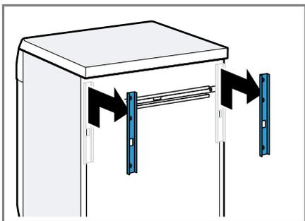
3. Desserrez et retirez les vis des sécurités de transport horizontales à l'aide d'un tournevis T20.
