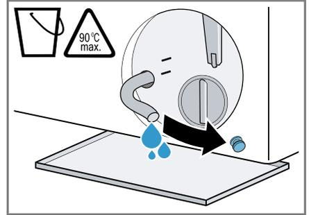
8. Appuyez sur le bouchon de fermeture.
