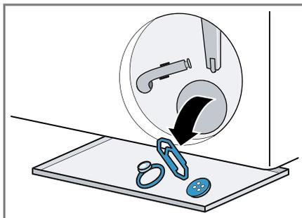
Le couvercle de la pompe se compose de deux composants qui sont démontables pour le nettoyage.
