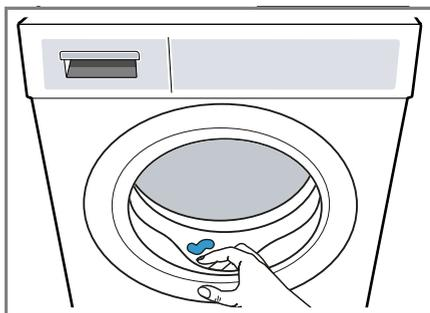
4. Laissez la porte de l'appareil et le bac à produits ouverts afin que l'eau résiduelle puisse s'évaporer.
