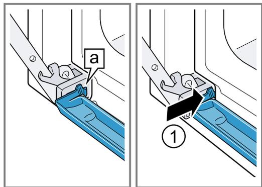
3. Appuyer sur le bac de condensation, jusqu'à ce que les crochets s'engagent à droite, à gauche et en bas.
