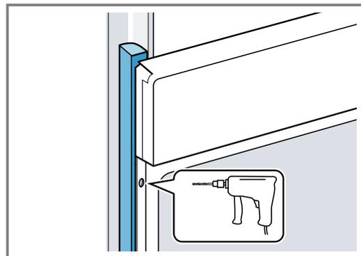
3. Fixer l'appareil avec une vis adéquate.
