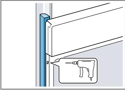
4. Fixez l'appareil avec une vis adéquate.
