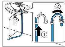
Poussez le tuyau d'évacuation d'eau complètement à travers le coude → Page 14 et fixez-le avec le matériel de fixation. Fixez le coude à une hauteur de 100 cm maximum.
