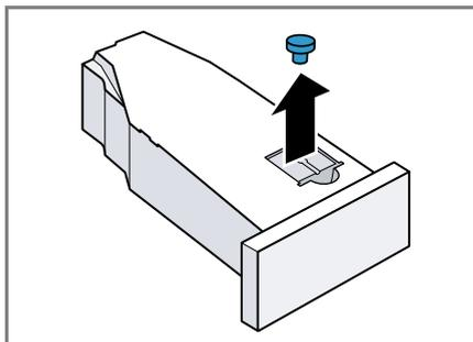
2. Mettez en place le bouchon sur la face inférieure.
