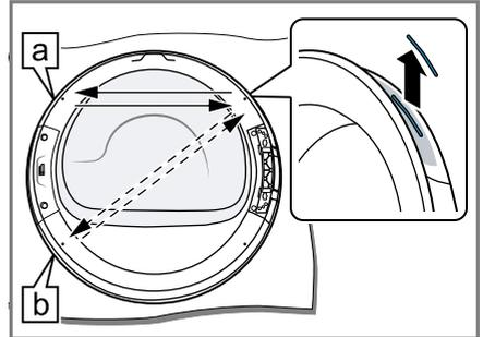
Choisissez la position de l'indicateur de poignée du hublot en fonction du lieu d'installation de l'appareil :
