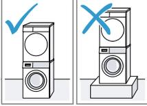
Installez cet appareil uniquement dans une colonne lave-linge/sèche-linge à l'aide du kit de raccordement d'origine du fabricant du sèche-linge.
