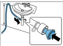
Fixez le point de raccordement avec un collier de serrage (12-22 mm). Fixez le tuyau d'évacuation d'eau avec un
