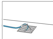
Poussez le tuyau d'évacuation d'eau complètement à travers le coude → Page 14 et fixez-le avec le matériel de fixation. Fixez le coude sur la bouche d'évacuation.
