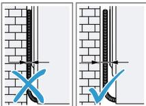
Ne coincez aucun tuyau ni aucun cordon d'alimentation secteur entre le mur et l'appareil.
