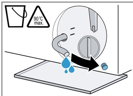
8. Appuyez sur le bouchon de fermeture.
