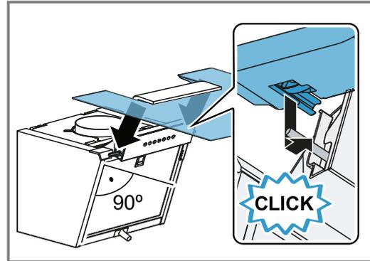
9. Introduire le support de vitre dans l'ouverture de la vitre et l'encliquer.
