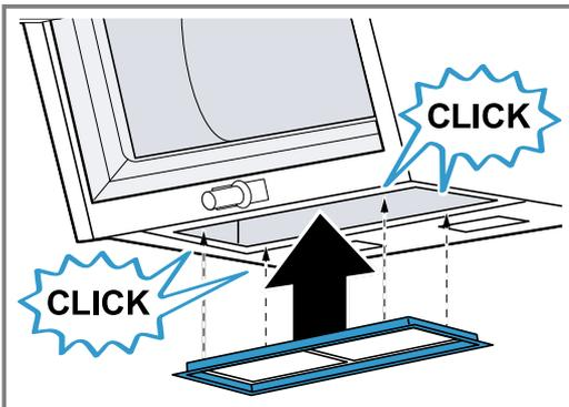
6. Insérer le support de la vitre dans l'ouverture et le rabattre vers le bas jusqu'à la butée.
