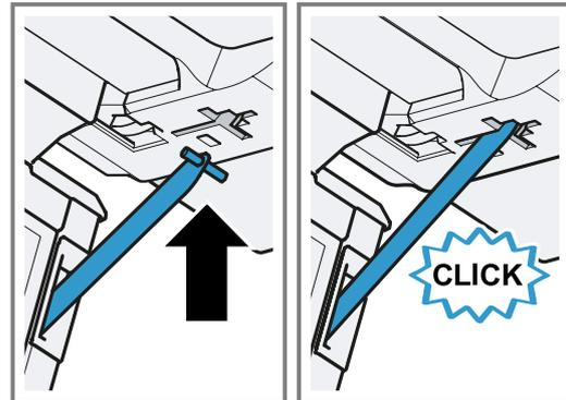
10. Insérer les filtres à graisse.
