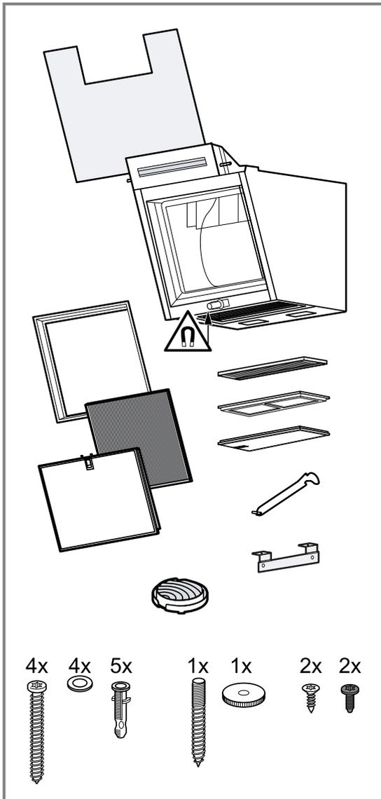
**Conseil :** L'équerre de fixation pour le cache de la cheminée ainsi que les petites vis argentées et noires sont comprises dans la livraison, mais ne sont pas nécessaires pour les appareils à air pulsé.
