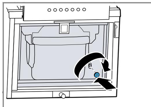
4. Placez le porte-filtre avant en haut, en biais, puis insérez-le dans les languettes. Appuyez sur le porte-filtre vers le bas de sorte qu'il se verrouille de manière audible.
