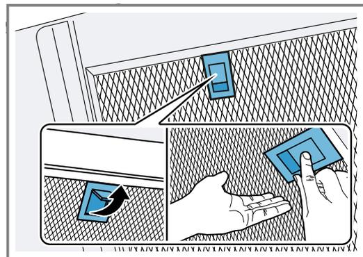
3. Retirez les filtres à graisse des fixations. Pour éviter l'égouttement de graisse, tenez les filtres à graisse à l'horizontale.
