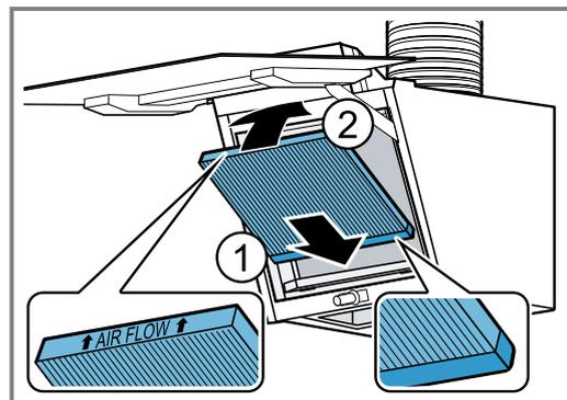
La mousse doit se comprimer au moment de l'insertion.
