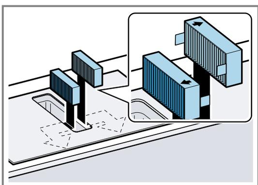
4. Insérez les autres filtres anti-odeurs ou filtres acoustiques à gauche et à droite de l'appareil.
