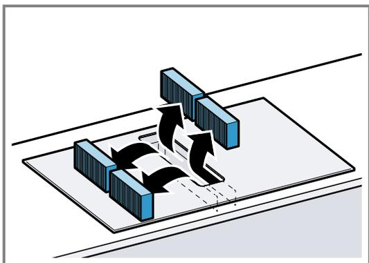
3. Insérez les deux nouveaux filtres anti-odeurs ou acoustiques à gauche et à droite de l'appareil, puis poussez-les vers l'avant.
