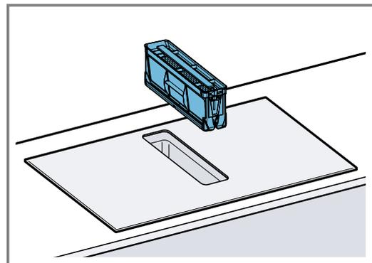
3. Retirez les 4 filtres anti-odeurs ou acoustiques et mettez-les au rebut de façon appropriée.
