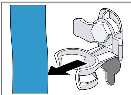
2. Dévissez les 4 vis des sécurités de transport à l'aide d'une clé à vis de calibre 13 ① et retirez-les ②.
