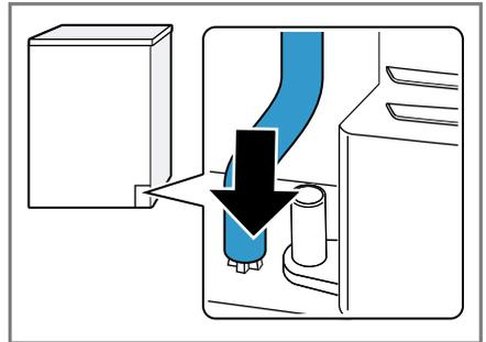
3. Poussez le tuyau d'évacuation d'eau sur le manchon jusqu'en butée.
