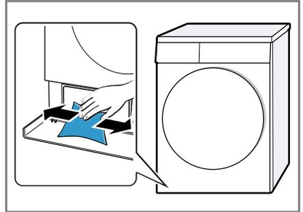
8. Insérez l'insert horizontalement jusqu'à ce que la patte s'enclenche.
