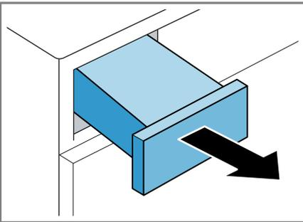
2. Vider le réservoir d'eau de condensation.
