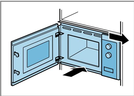
**3. Visser l'appareil jusqu'à ce qu'il soit centré.**
