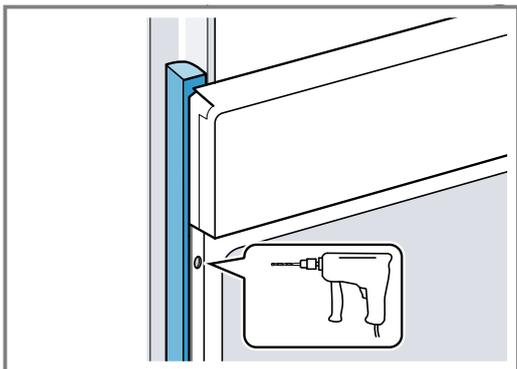
4. Fixez l'appareil avec une vis adéquate.
