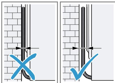
Ne coincer aucun tuyau ni aucun cordon d'alimentation secteur entre le mur et l'appareil.
