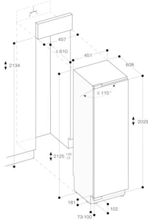
Les dimensions maximales de l'habillage de la porte sont basées sur un écart de 3 mm.
