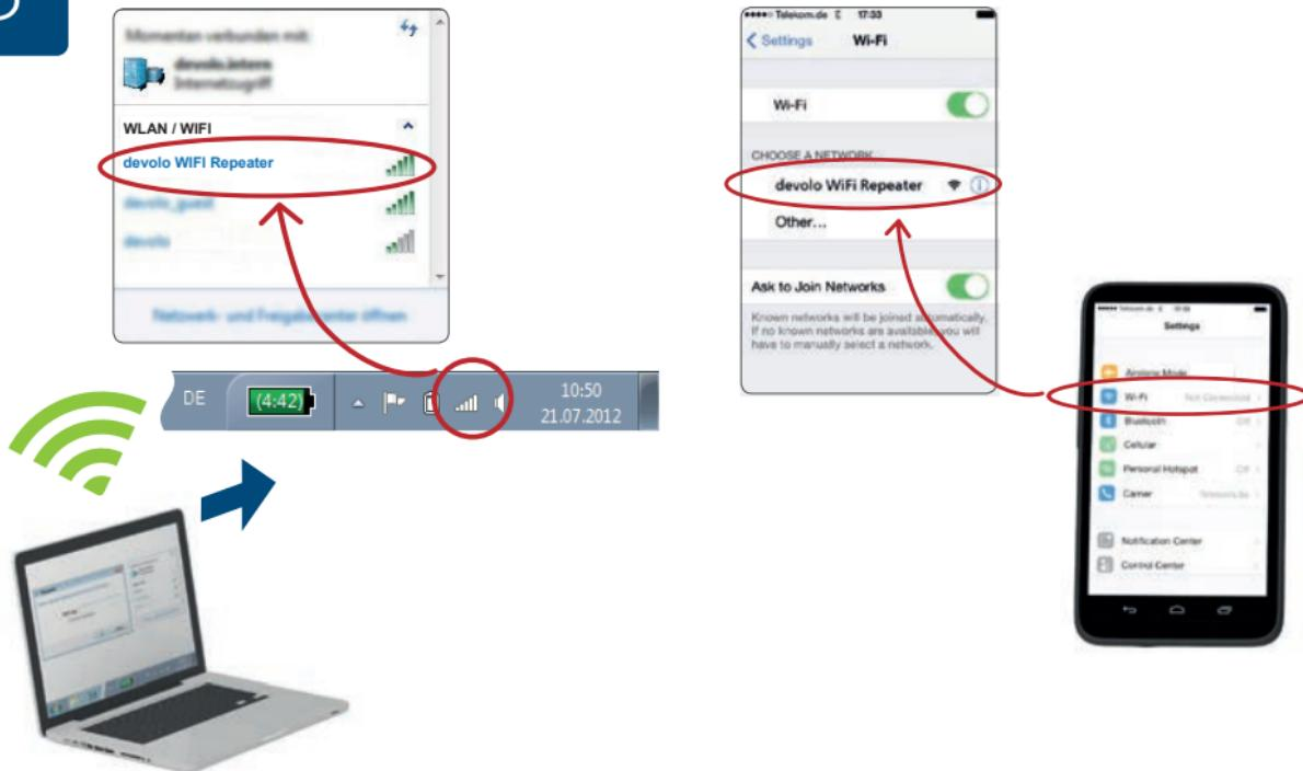
Öffnen Sie das WLAN-Konfigurationsmenü des Endgerätes (PC, Notebook, Tablet) und verbinden Sie sich mit dem Netzwerk „devolo WiFi Repeater“.
