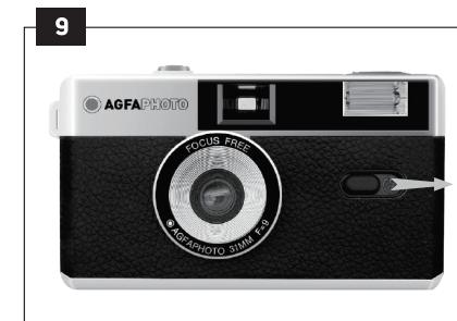
**DE** Einschalten des Blitzes. Schieben Sie den Blitzschalter nach rechts. Die Kamera ist blitzbereit, sobald die Blitzanzeige-LED auf der Oberseite rot leuchtet.
