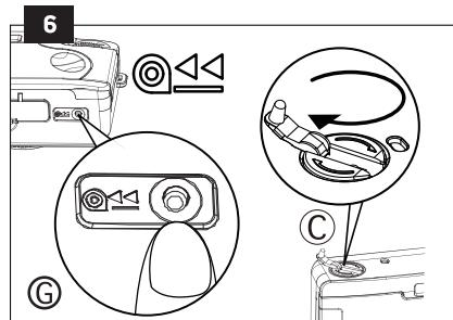
**DE** Nachdem alle Bilder aufgenommen wurden, drücken Sie die Rückspultaste **G** auf der Unterseite der Kamera. Drehen Sie die Filmrückspulkurbel **C** im Uhrzeigersinn, bis der komplette Film zurück in die Patrone gespult wurde.
